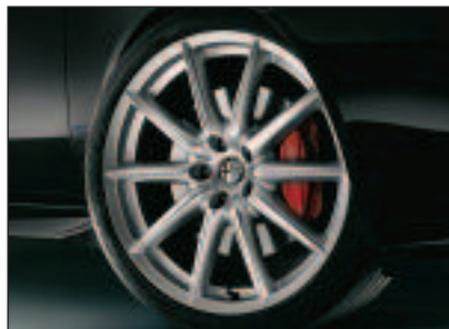
Jantes en alliage 19", freins avant monobloc en aluminium rouge
